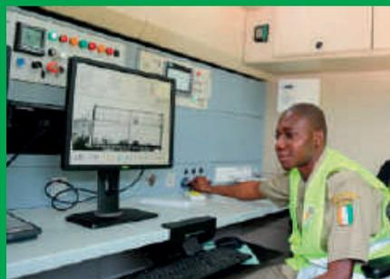
Les scanners à rayons X permettent de réaliser des contrôles non intrusifs en visualisant sur un écran, l'ensemble d'une cargaison, en lieu et place des dépotages systématiques.
